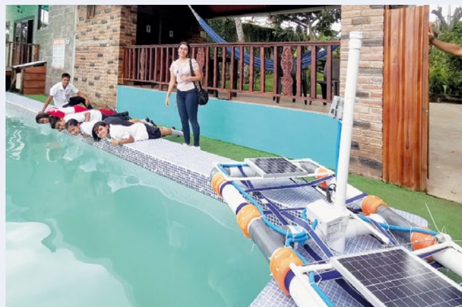
Estudiantes prueban el prototipo de un sistema embebido de navegación satelital para la investigación de cuerpos acuáticos.
